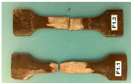
Figure 3. Broken test piece F1
